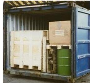
**Figura 7.28 Estiba mixta, con uso de palets**
