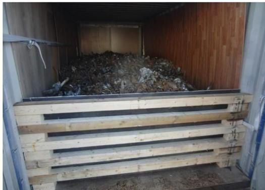
**Figura 7.55** Unidad de transporte con paredes revestidas y una barrera de puerta con chatarra
