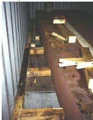
Figura 7.45 Bloqueo transversal de chapa gruesa de acero
