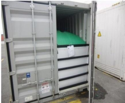
Figura 7.51 Contenedor provisto de flexitanque
