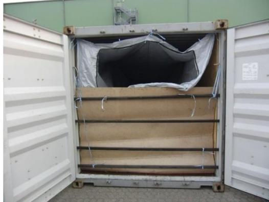
**Figura 7.54** Unidad de transporte con un saco de revestimiento para carga a granel delicada
