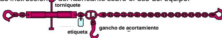
**Figura 7.18 Cadena de trinca normalizada con gancho de acortamiento**
