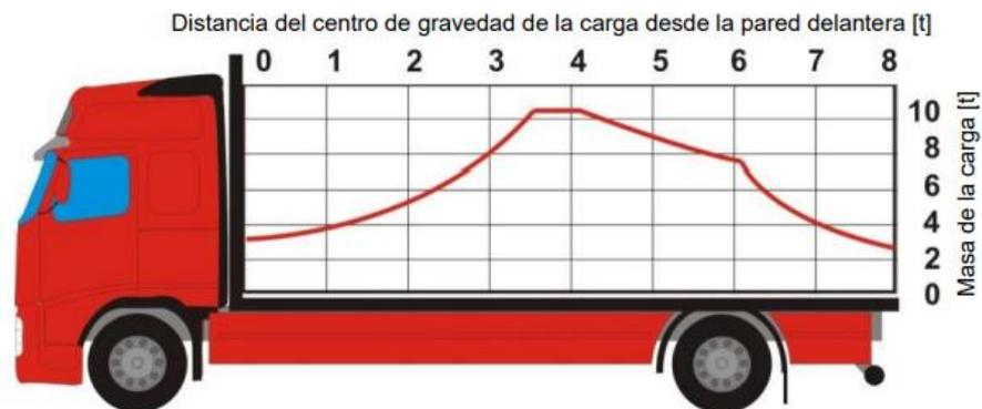
Figura 7.22 Ejemplo de un diagrama de distribución de la carga de un camión rígido
